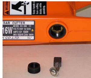
**VORSICHT:** Abgenutzte Bürsten führen zu einem Leistungsabfall, wodurch der Motor heiß läuft und die Armatur irreparabel beschädigt wird.
